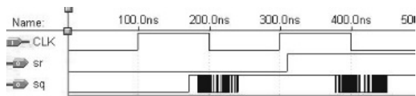
Figura 5: Señal: Reloj (CLK), Salida con Registro (sr) y Salida sin Registro (sq)
