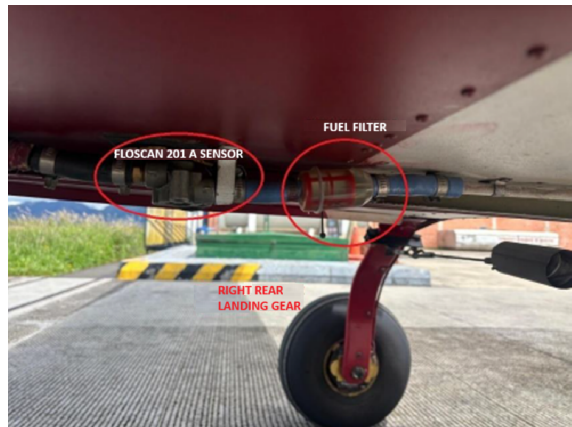
Figura. 6. Instalación del sensor FLOSCAN 201A en el avión LSA del proyecto.
