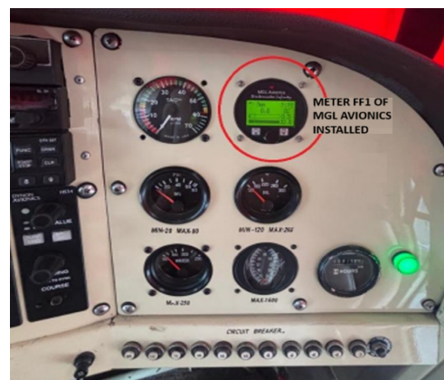
Figura. 6. Instalación del sensor FLOSCAN 201A en el avión LSA del proyecto.
