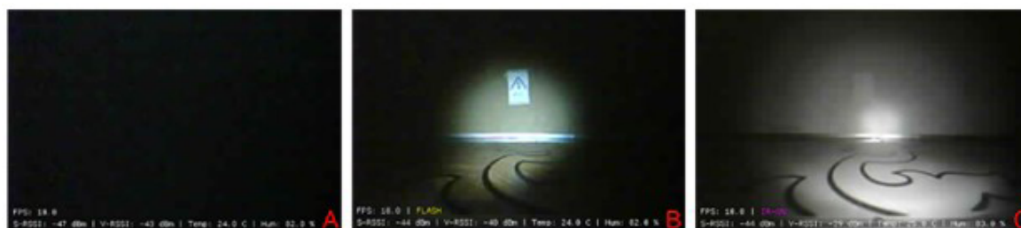
Figura 14. A) Sin iluminación B) Linterna C) Iluminación IR (Fuente: Autores)
