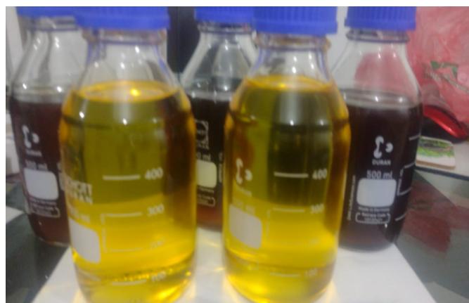
Figura 4. Biodiésel obtenido de los aceites Sacha Inchi (delantero) y Sejé (trasero)
