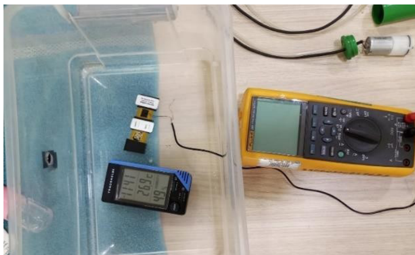
Figura 3. Configuración experimental para la prueba de humedad de los sensores
