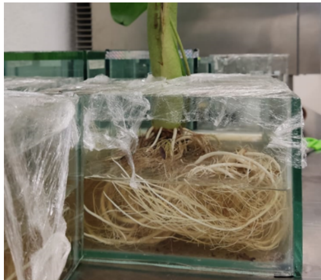
Figura 1. Sistema radicular y rizoma en contacto con aguas grises durante el proceso de fitorremediación. Fuente: Elaboración propia.
