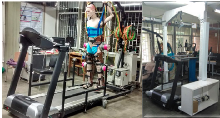
Figura 3. Plataforma de rehabilitación asistida de la marcha humana, RUVEM (14)
