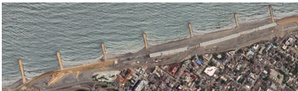
Figura 12. Imágenes satelitales de zona de obra Julio 2014 se coloca arena de protección por evidencia de erosión (32)
