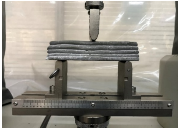
Figura 15. Montaje del ensayo de resistencia a la flexión realizado a las mezclas cementicias. Ensayo a tres puntos de una viga de 140 x 40 40 mm.
