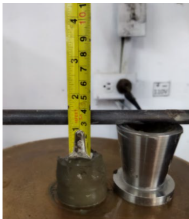
Figura 2. Ensayo de asentamiento (minislump).
