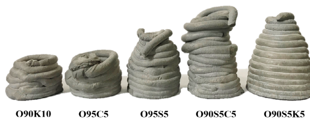
Figura 8. Inspección visual de las mezclas realizada durante la prueba de extrusión preliminar.
