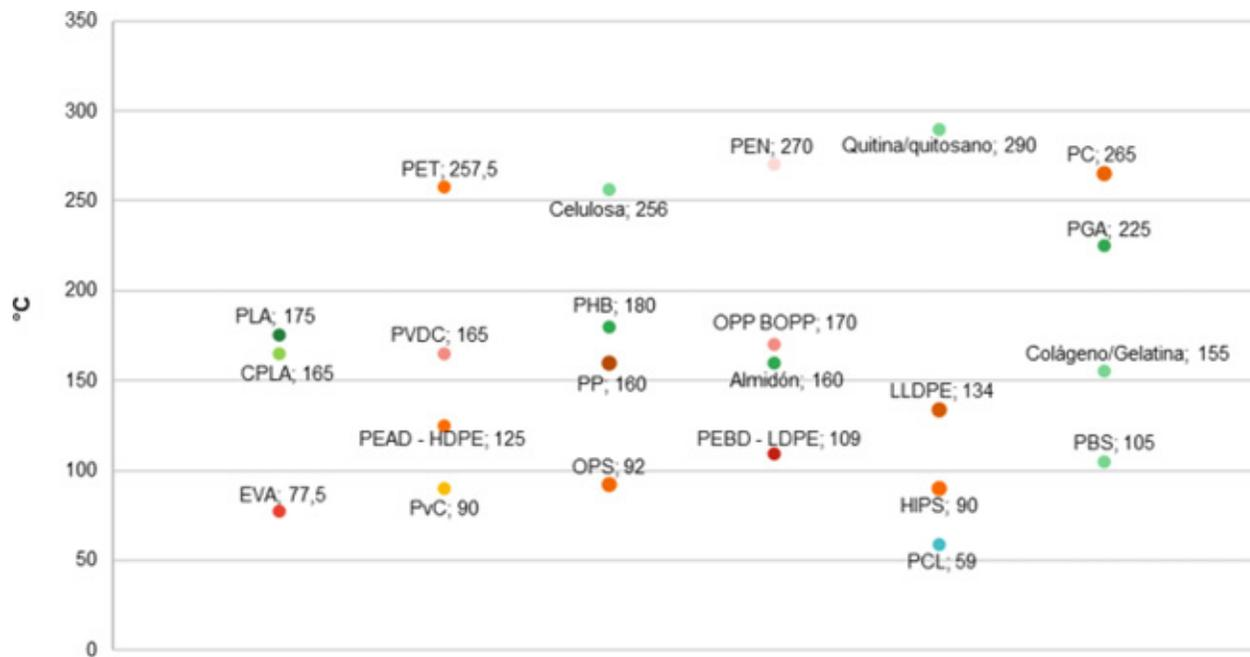
Figura 4. Punto de fusión empaques y bioempaques analizados
