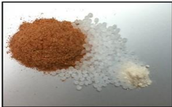
Figura 1. Harina de madera, LDPE, y Aditivo Struktol TPW113.
