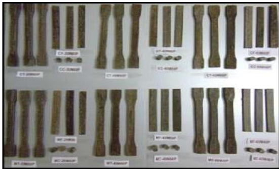
Figura 5. Probetas normalizadas para ensayos mecánicos de tracción, flexión y compresión de las seis composiciones básicas del compuesto.
