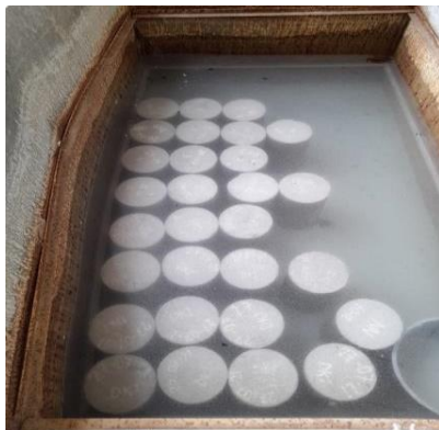
Figura 1. Cilindros curados en inmersión
