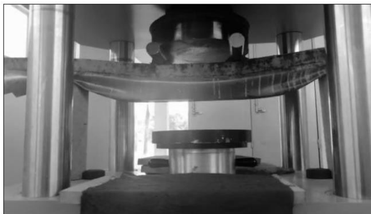
Figura 12 Falla de la sección compuesta
